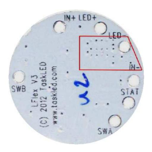
Le polygone rouge délimite la zone minimale qui doit être refroidie en la couplant à un radiateur avec de la pâte thermique. Il est préférable de monter l'ensemble de la face arrière LFlex sur un radiateur car cette augmentation de la surface refroidie améliorera la dissipation thermique.
