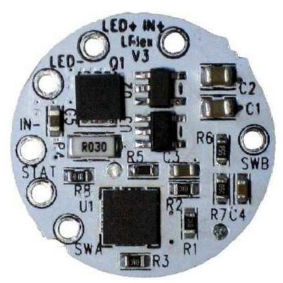
L'illustration précédente montre la face supérieure du LFlex V3. L'alimentation se fait en courant continu (DC) via une batterie ou une alimentation par les plots IN+ (pôle positif) et IN- (pôle négatif).
